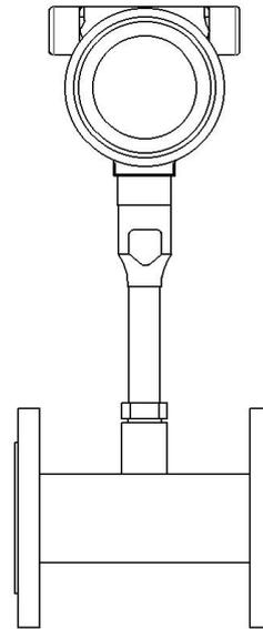
Fig. 2 Flanged Flow Meter
