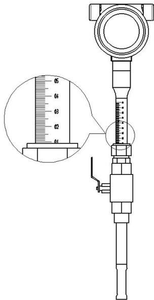
Fig. 1 Standard Insertion Flow Meter
